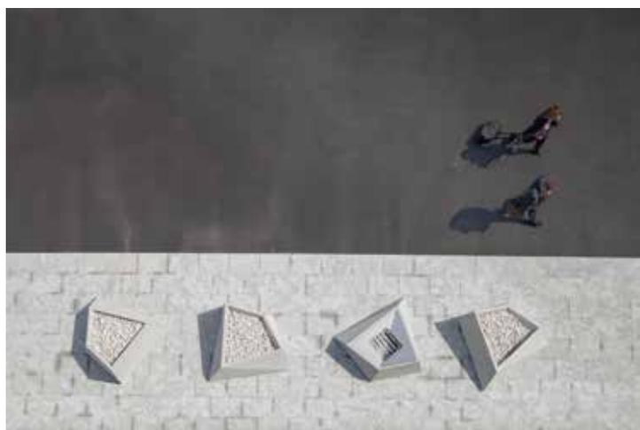
FR-Banc en béton coloré en masse, decapéé et imperméabilisé.
